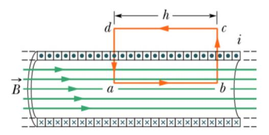
$$\oint \vec{B} \cdot d\vec{s} = \int_{a}^{b} \vec{B} \cdot d\vec{s} + \int_{b}^{c} \vec{B} \cdot d\vec{s}$$
